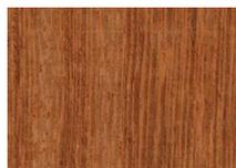
Madeira muito durável, com boa resistência ao ataque de fungos e insectos xilófagos. Dura ao corte. Os riscos de deformação e de abertura de fendas são mínimos. Permite bons acabamentos. É aplicada principalmente em pavimentos.
