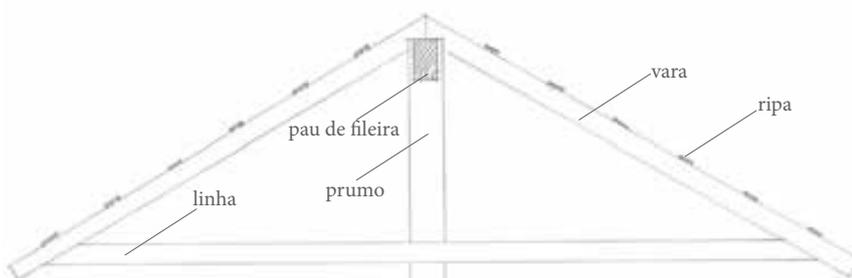
[50a]. Corte da estrutura da cobertura sem telhas.
